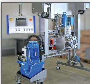
Anfahrventil und Hydraulikaggregat in den Maschinenrahmen integriert
