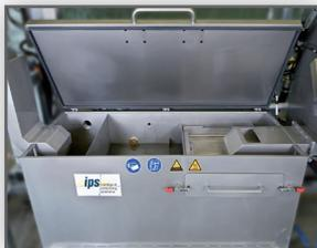
Prozesswasserbehälter mit integrierter Filterschublade
