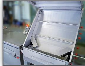
Bogensieb mit zusätzlicher Filterschublade (optional)
