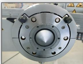
Optimaler Zugang zur Lochplatte für einen schnellen Lochplattenwechsel
