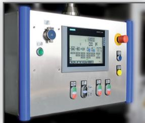
Ergonomische Anordnung des Bedienfeldes mit Hart-Taster-Bedienung der wichtigsten Prozessfunktionen
