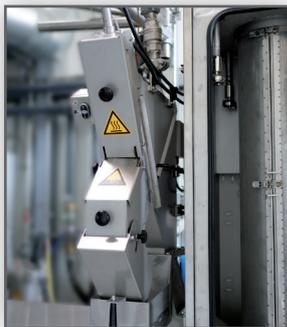
Agglomeratabscheider mit pneumatisch betriebem Schieber (Abdichtung ohne Dichtmaterial) und automatischer Ausschleusung (optional)
