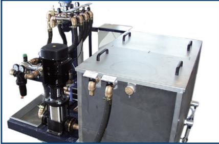
Prozesswassersystem mit Filtrierung und Temperierung
