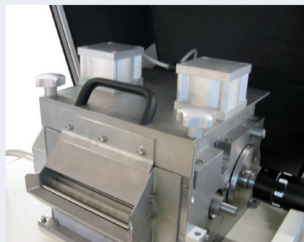
Bei allen Baugrößen zwei Andruckzylinder der oberen Einzugswalze für bestes Einzugsverhalten
