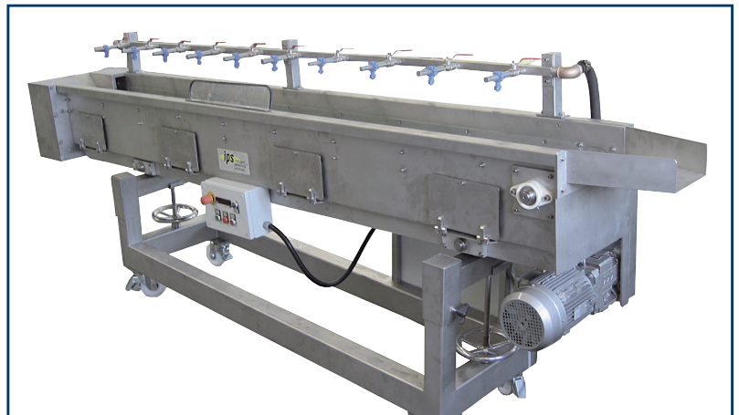
Variante: Nur Sprühwasserkühlung
