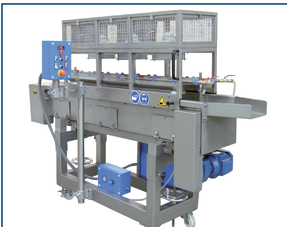
Variante: Kühlung durch Wassernebel (pneumatische Zerstäuberdüsen) und durch Luftströmung (Ventilatoren drehzahlgesteuert) mit Staubfilterung
