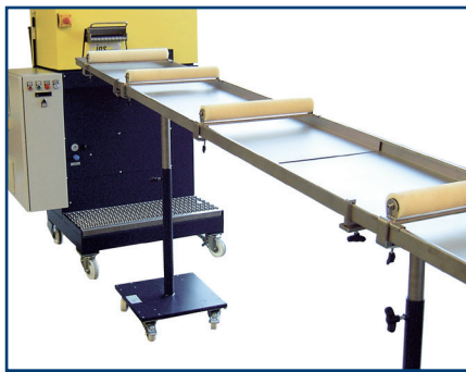
Strangzuführung von Strangkühlwanne zum Stranggranulator
